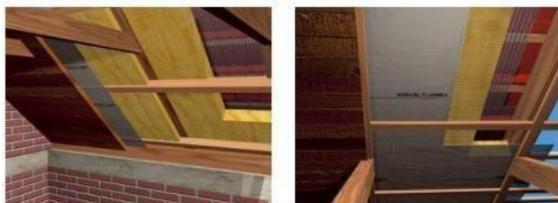
Obr. č. 10 Izolácia podkrovia
